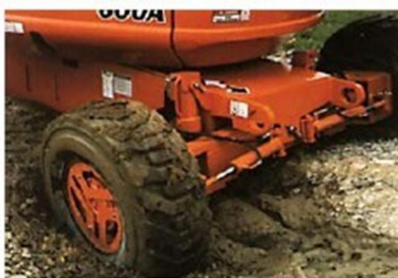
Eixo oscilante trabalhando em terreno acidentado
